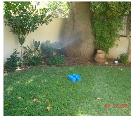
図3 - 灌漑設備の質を検証する試験 1 。写真: Dani Katz
