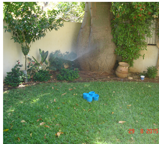
Obrázok 3 – Testovanie nainštalovaných závlah. 1 Foto: Dani Katz
