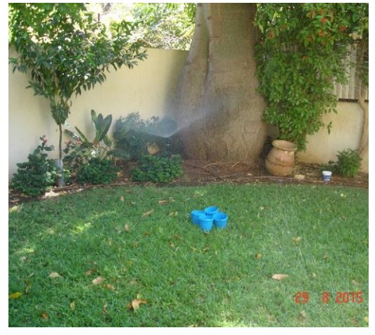
Resim 3 - Sulama Montaj kalitesinin test edilmesi 1 . Fotoğraf: Dani Katz
